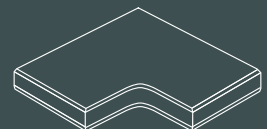
| AF 50/GetaCore® | one piece corner top L-form 900 x 900 x 610 x 49 mm
